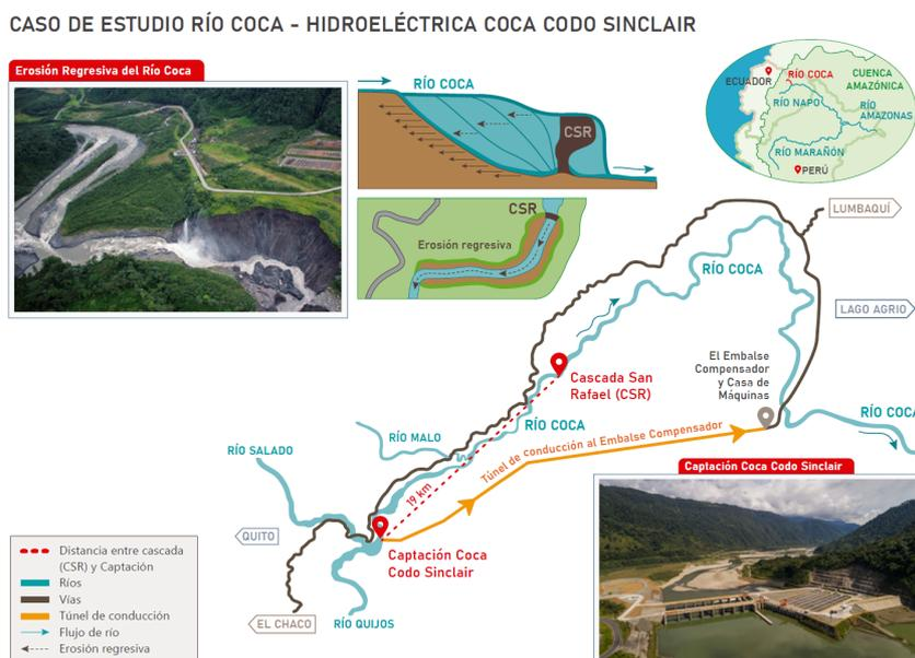
Nota: En este esquema se muestran diferentes vistas de la erosión regresiva de la cascada San Rafael y la ubicación de las estructuras principales de la Central.
